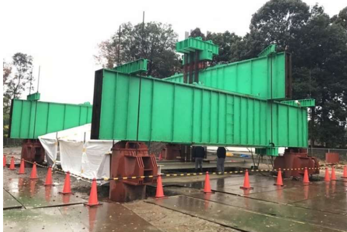
写真 1 構造性能を確認するための載荷試験状況
