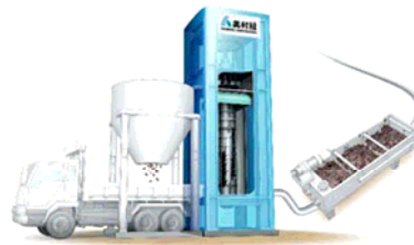
▲ スラリー連続脱水システムイメージ (縦型スクリープレスを使用)
