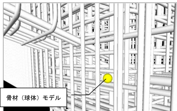
図－4 骨材通過シミュレーション
