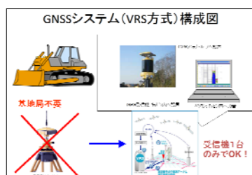
図-2 GNSS(VRS 方式)機器構成
