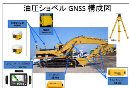
図-1 マシンガイダンス(バックホウ)機器構成
