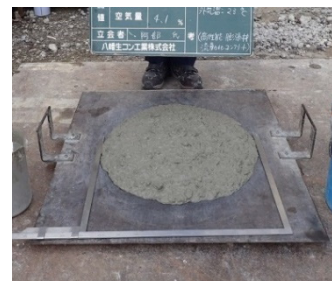
高流動化コンクリート （スランプ フロー 45～60cm）
