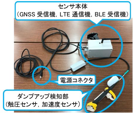
写真-1 ダンプアップ検知センサ
