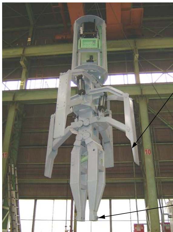
写真-1 レンガ解体機全景
