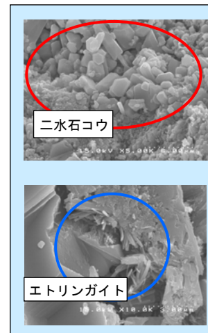
図-8 腐食生成物 SEM 画像
