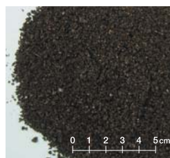
下水汚泥熔融スラグ
