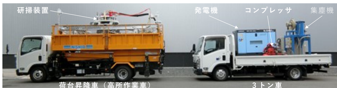
写真-1 天井用車載型乾式研掃システム
