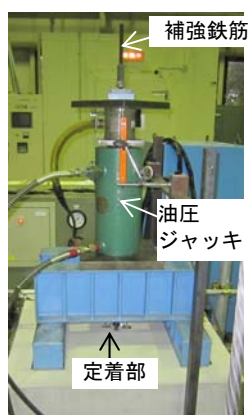
引抜き試験状況
