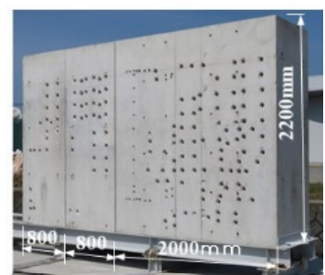
写真-5 実験後のRC壁試験体
