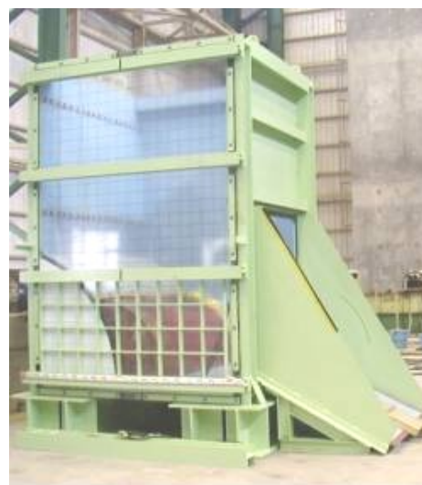
間詰め材充填土槽実験装置
