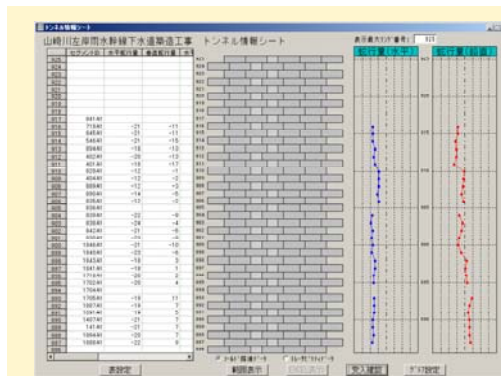
セグメント情報管理システムの トンネル情報シート
