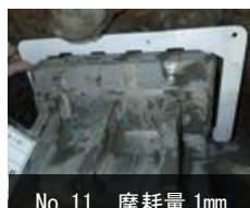
写真-3 ビット点検状況
