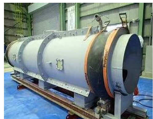
写真-2 実物大の充填実験用鋼製型枠
