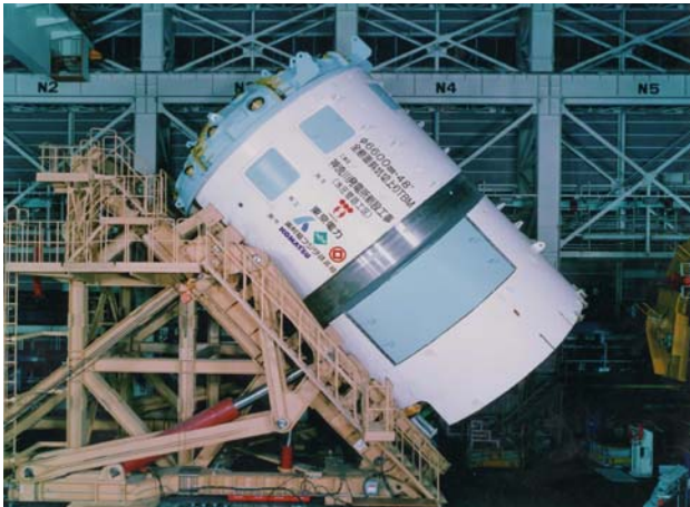
全断面斜坑TBM傾胴(勾配 48 度)
