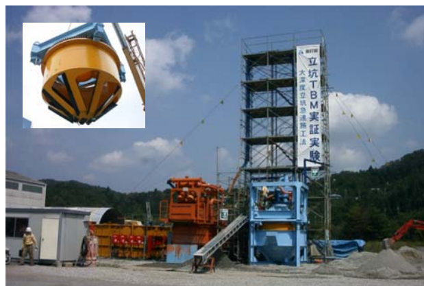
立坑TBM実証実験装置 (実証実験装置全体及びφ2.4m カッタヘッド)
