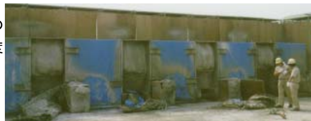
ベースコンクリートの状態 スランプフロー 45cm
