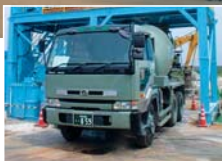
製造コンクリートを ミキサー車で運搬
