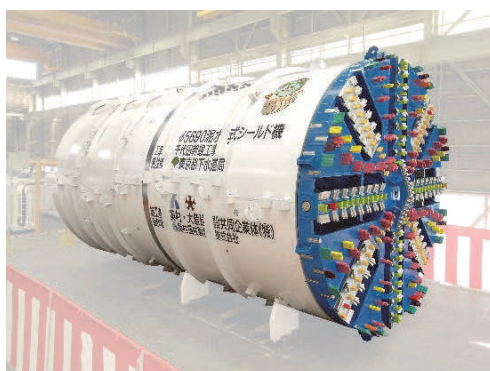
千代田幹線で使用したシールドマシン
