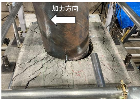
写真-1 試験体 No. 1 上面の破壊状況 ( R = +10\% 時)
